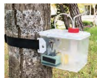
▲フクロウのDNAを採取する吸引装置。安価な材料と3Dプリンターで自作したパーツを組み合わせている
