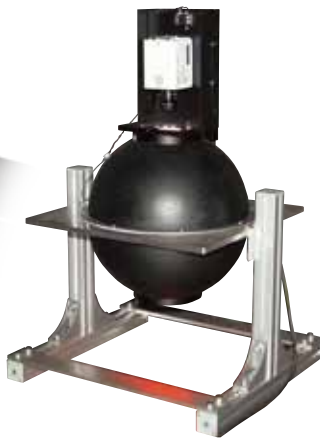
電子色票と忠実色再現カメラを組み合わせた自動分光設計装置。例えば、ケーキがおいしく見える照明スペクトルを見つけることができる。
