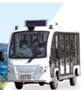
遠隔操作システムを用いた試験走行。エコパの園路は準公道。公道の環境を有するが、閉め切れば他車との混在を回避できる。
