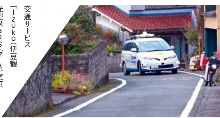
松崎町の狭隘道路を走行する自動運転車。レーザーで周囲の状況を感じながら、自動運転用のベクトル地図で自車位置を確認している。
