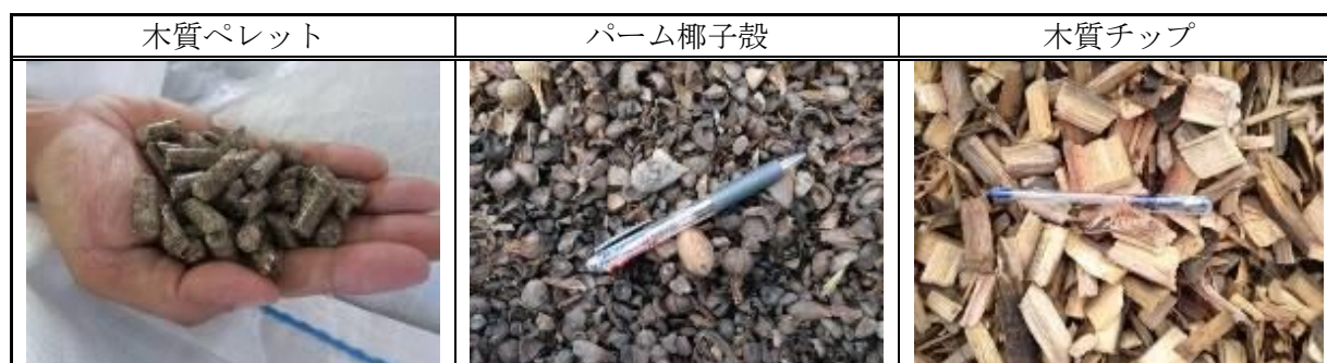
図 2-5 木質ペレット、パーム椰子殻、木質チップの写真例
