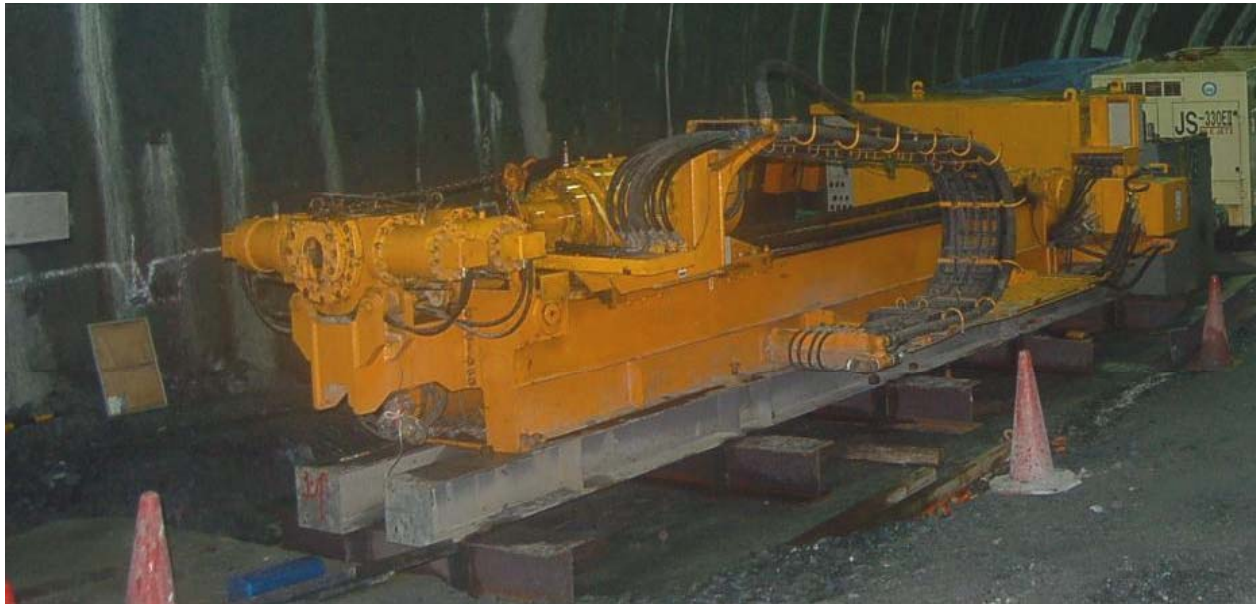
写真 先進ボーリングマシン
