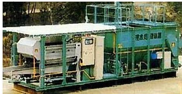
濁水処理装置の設置の例
