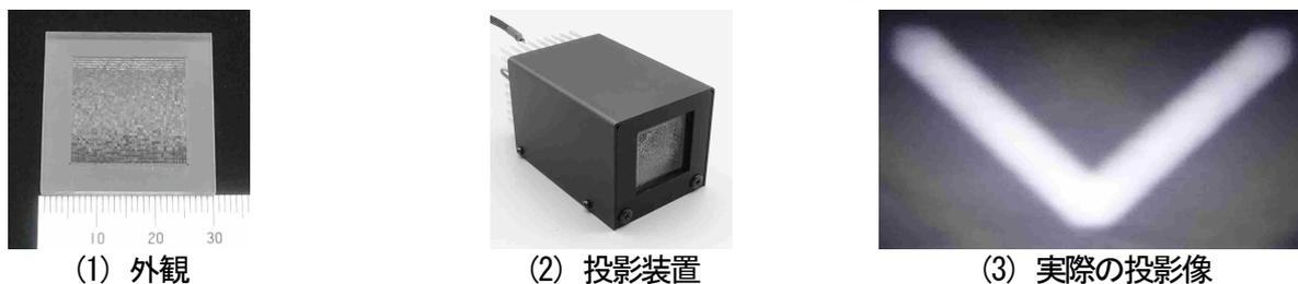
図3 切削加工で成形したマイクロプリズムアレイ
