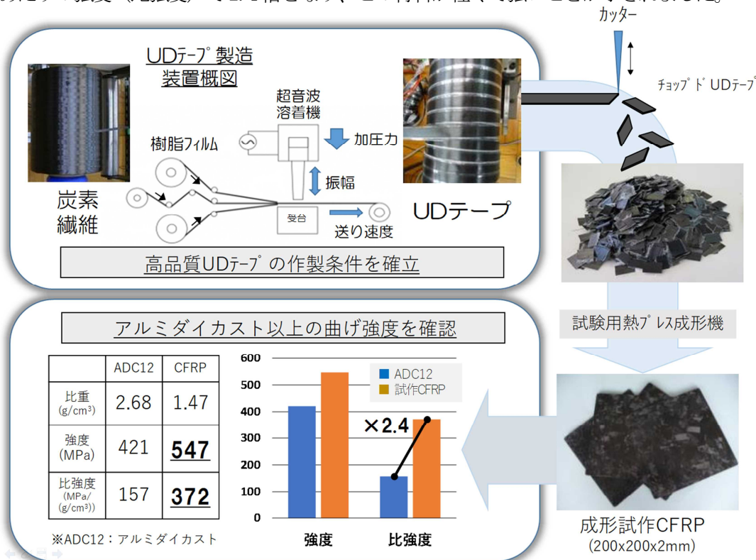
図1 CFRPの基材となるUDテープの製造とUDテープを用いた成形品の強度
