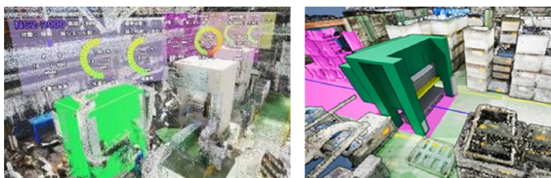
図4 生産状況の見える化（左、稼働情報を3DCGモデル上に表示）と設備の搬入経路シミュレーション（右）
