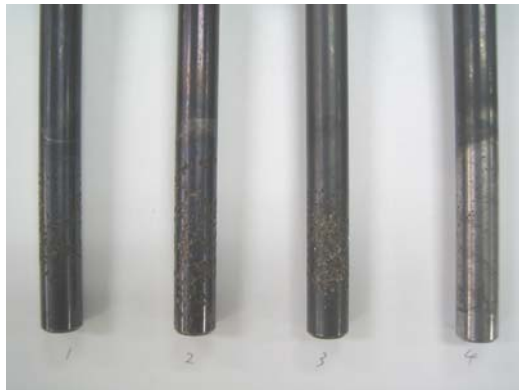
図3 溶解アルミで溶損試験を行ったダイカストピン
