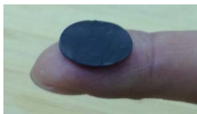
コーヒーかすから作った電池の材料
