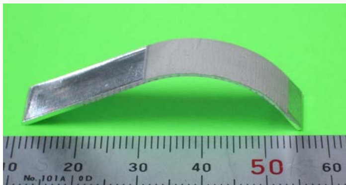
図 4 レーザによる板曲げ加工（純アルミニウム、板厚 1mm）
