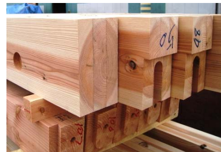
プレカット加工した積層合わせ梁
