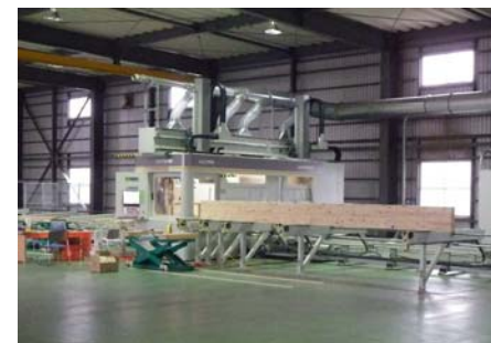
(株)スカイ・豊岡第 2・金物工場の CLT・大断面プレカット加工機 (磐田市上野辺)
