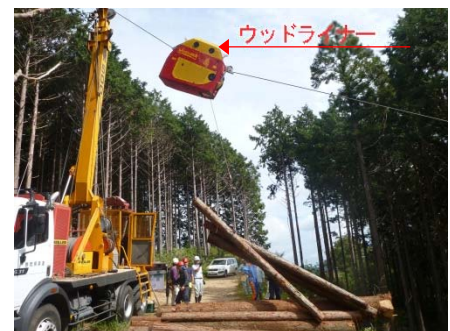
自走搬器「ウッドライナー」による集材作業 (島田市川根町)
