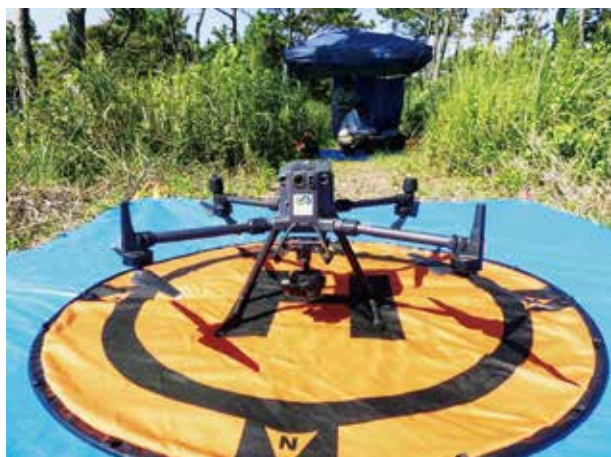
サーマルカメラ搭載ドローン
