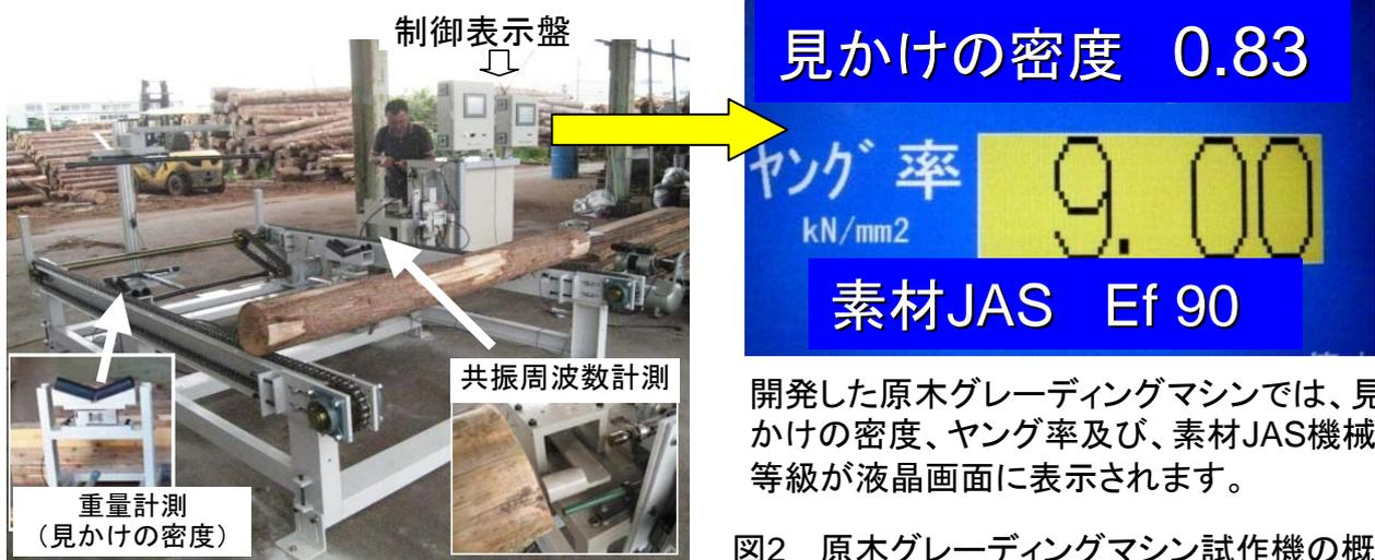
開発した原木グレーディングマシンでは、見かけの密度、ヤング率及び、素材JAS機械等級が液晶画面に表示されます。
