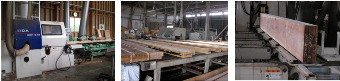
モルダー加工機による積層接着終了後の材面仕上げ
