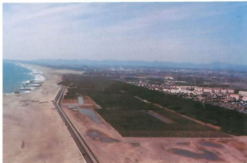
整地が進み植栽を計画的に実施。湿地帯の地下水位を下げるため、所々に素掘の池を作る。(P 4 参照)
