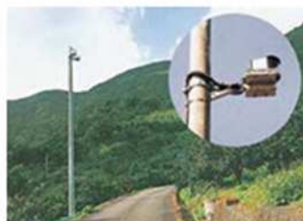
24時間地すべりを監視する CCD カメラ
