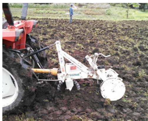
(3) 大豆栽培における心土破碎、サブソイラーを用いた弾丸暗渠施工と堆肥施用 (平成25年度、JA御殿場)
