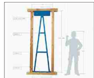
木造住宅専用油圧式制震装置「SEA-Device」の構造
