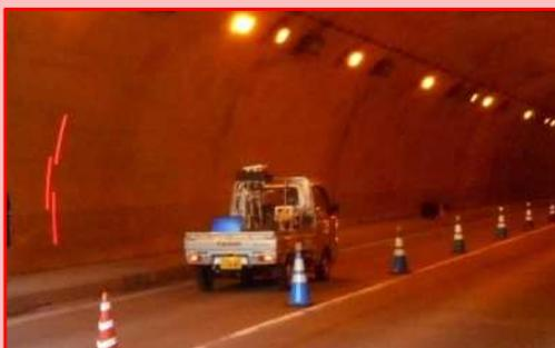
レーザー打音検査の実証実験（トンネル）
