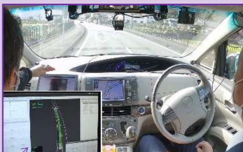
3次元点群データにより作成した自動運転用地図
