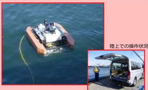
水中ドローンによる係留施設の点検
