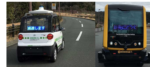
後続車の不満の低減に向けた電光掲示板による情報提供
