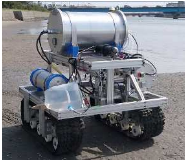
マルチビームSBP搭載クローラー“音響モグラ”
