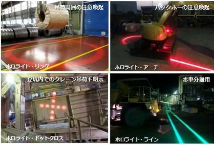
<労働災害を低減する安全用注意喚起照明 使用事例>
