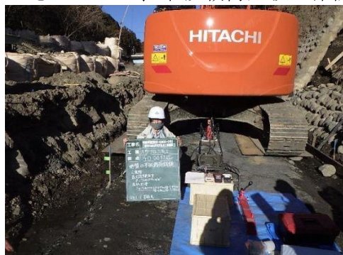
水に触れると軟弱になり地耐力が確保 できないため、平板载荷試験で確認
