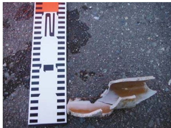
写真4: 孔内から採取した管の破片
