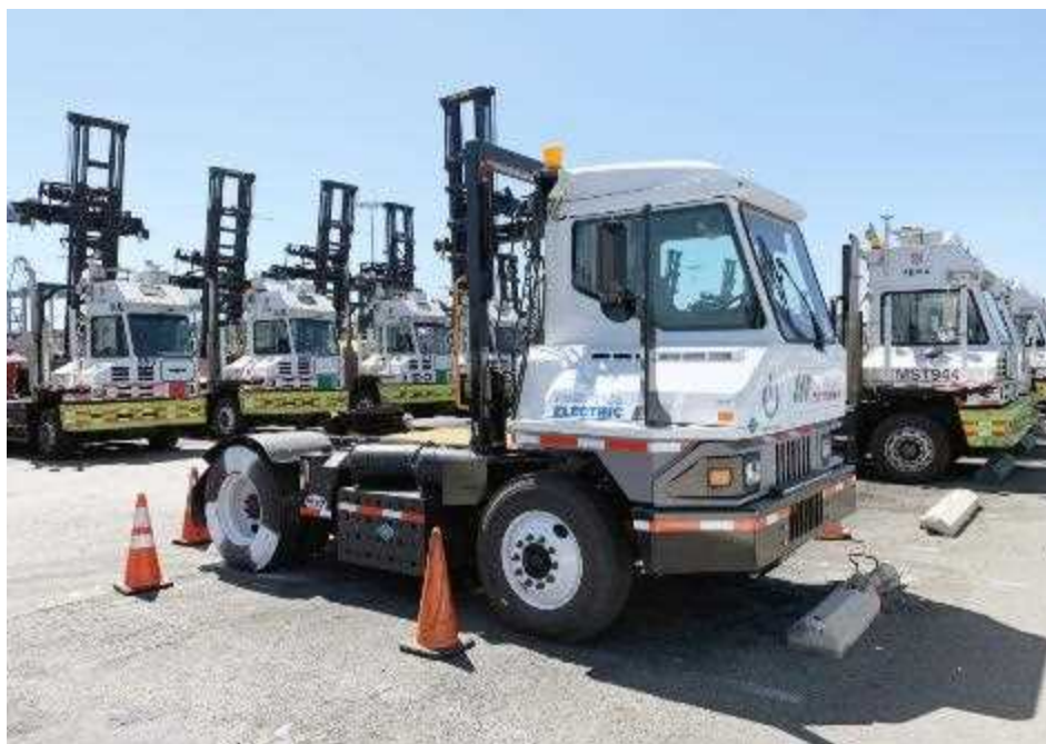
図 14:トヨタモーターノースアメリカの燃料電池式構内トラクターヘッド「UNO」
