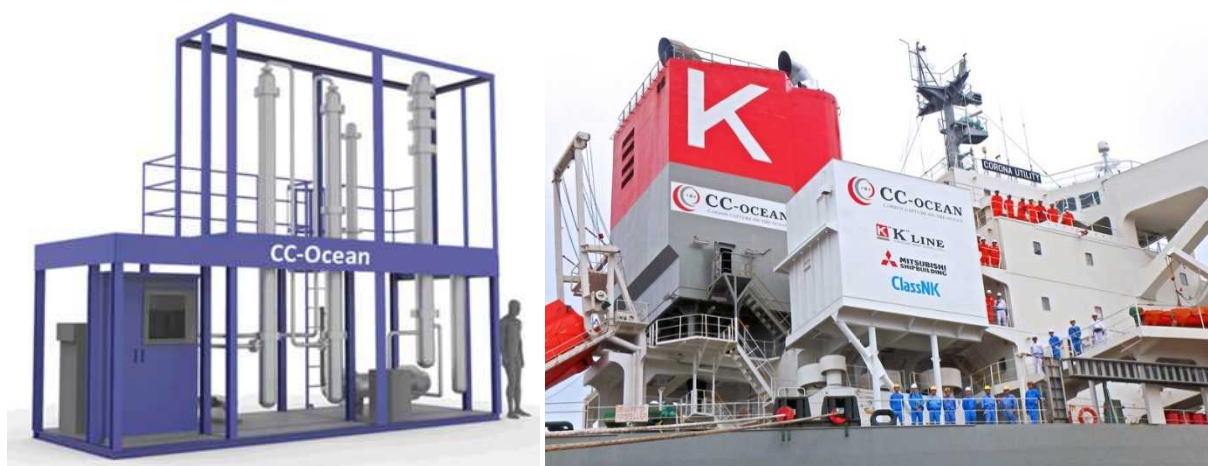
図 45:CO2 回収デモプラント イメージ図(左)、本船に搭載完了した CO2 回収小型デモプラント(右)
