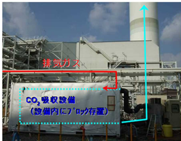
図 52:コンクリート1m 3 当たりの CO 2 排出量の試算結果及び炭素化養生設備
