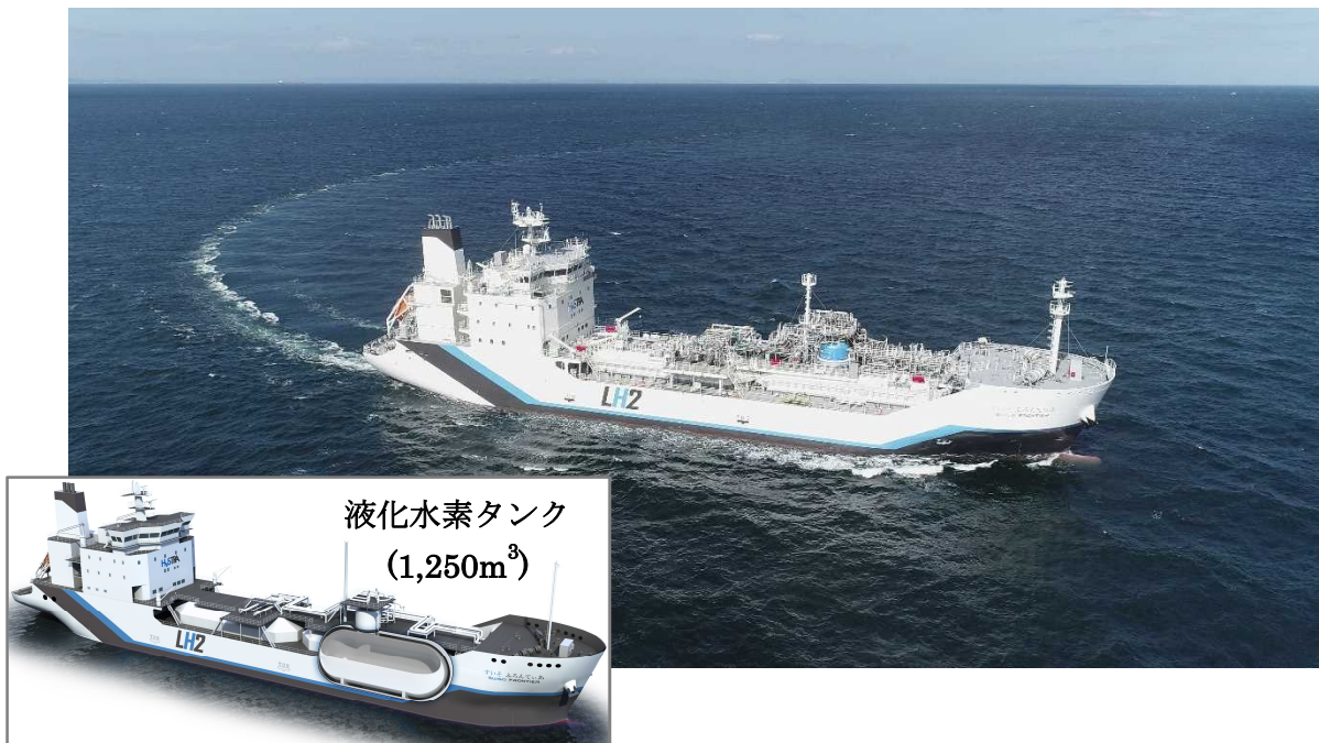
図 18: 実証船「すいそ ふろんていあ」航行写真(海上試運転時)とイメージ図
