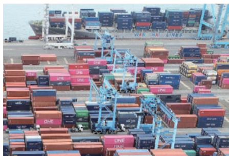
遠隔操作化に向けて新設や改造を行う電動式トランスファークレーン
