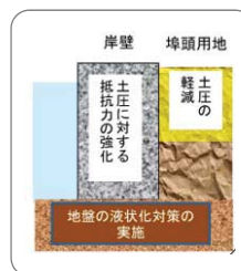
耐震強化岸壁整備の推進
