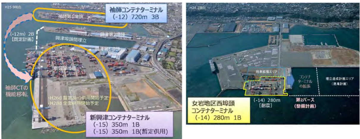
図 3-13 清水港・御前崎港のコンテナターミナル利用状況と整備計画
