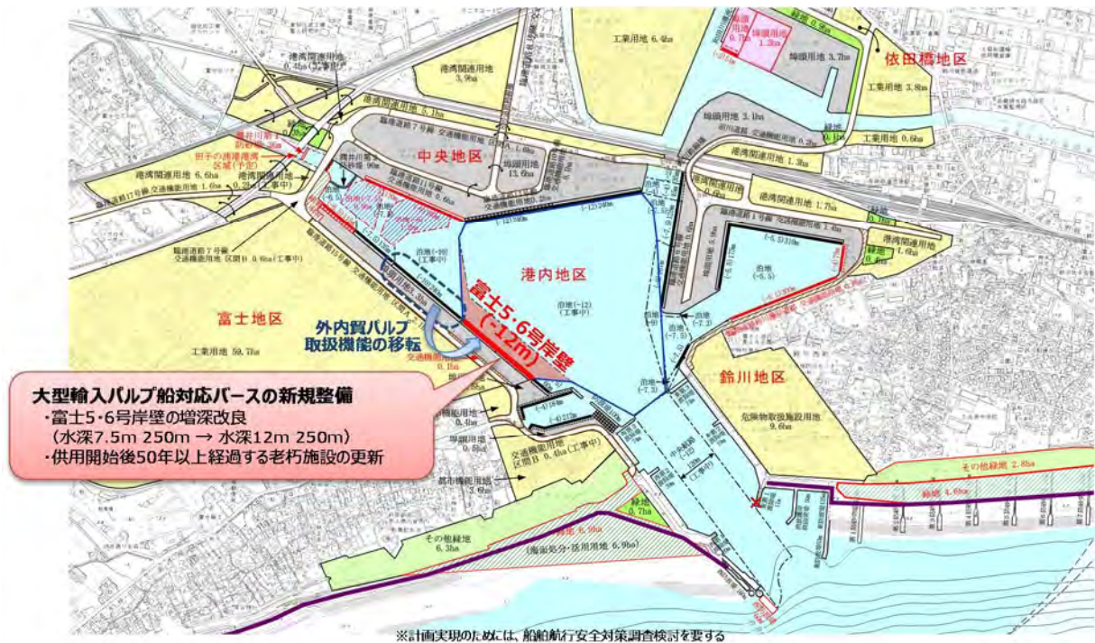
図 2-10 田子の浦港の輸入パルプ船対応ターミナルの整備イメージ
