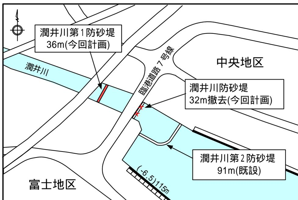
図 2 - 1 - 1 新規に計画する防砂堤の位置図
