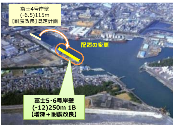
田子の浦港における耐震強化岸壁の配置計画
