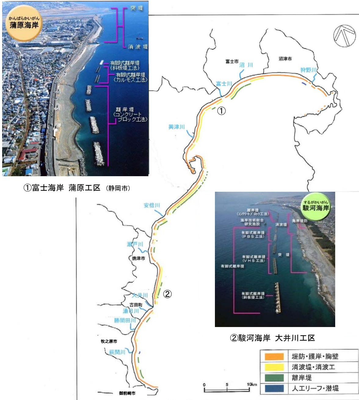
海岸保全施設の整備状況
