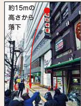
2015年2月、札幌市内の飲食店ビルの外壁に取付けられた看板の一部が落下し、歩道を通りしていた女性の頭部に当たり重傷を負わせる事故が発生しました。外壁への取付け部品が腐食したことで強度が低下し、強風の影響で落下したものとみられています。
