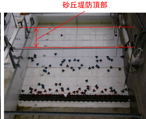
実験後のテトラポッドの状況
