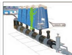
マンホールトイレ
