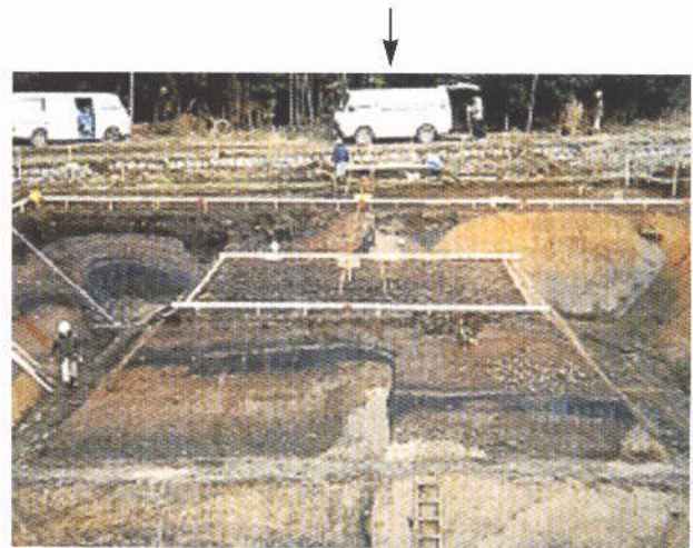
写真8 丹那断層(丹那盆地中央部)でのトレンチ調査(撮影 松田時彦)
