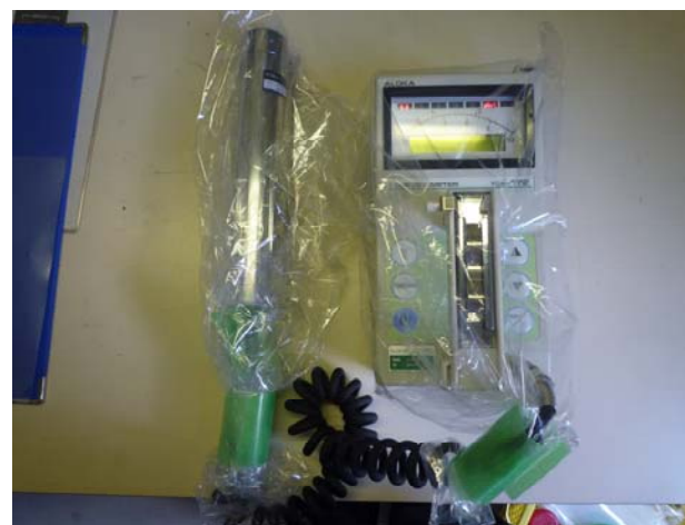
NaI(Tl)シンチレーション式サーベイメータ (株)日立アロカメディカル社製 TCS-172
