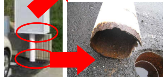
↑柱根元のサビを放置し、倒壊。
