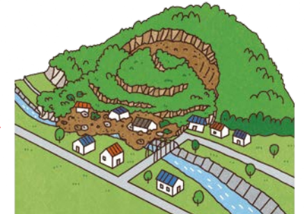
おし出された土砂が道路や人家に大きな被害になる。
