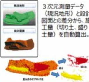
3次元測量データ（現況地形）と設計図面との差分から、施工量（切り土、盛り土量）を自動算出。
