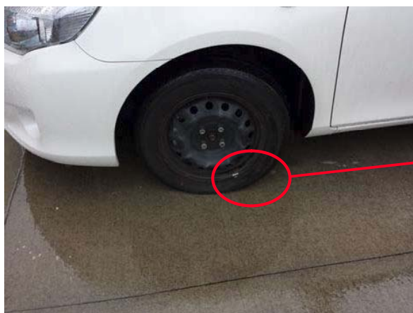
車両損害状況 (タイヤパンク)
