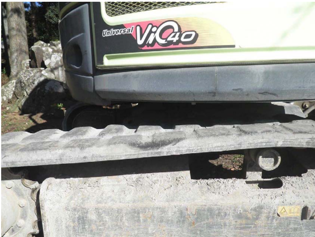
消防車両に接触した建設機械 (0.20BH) のゴムキャタピラ部
