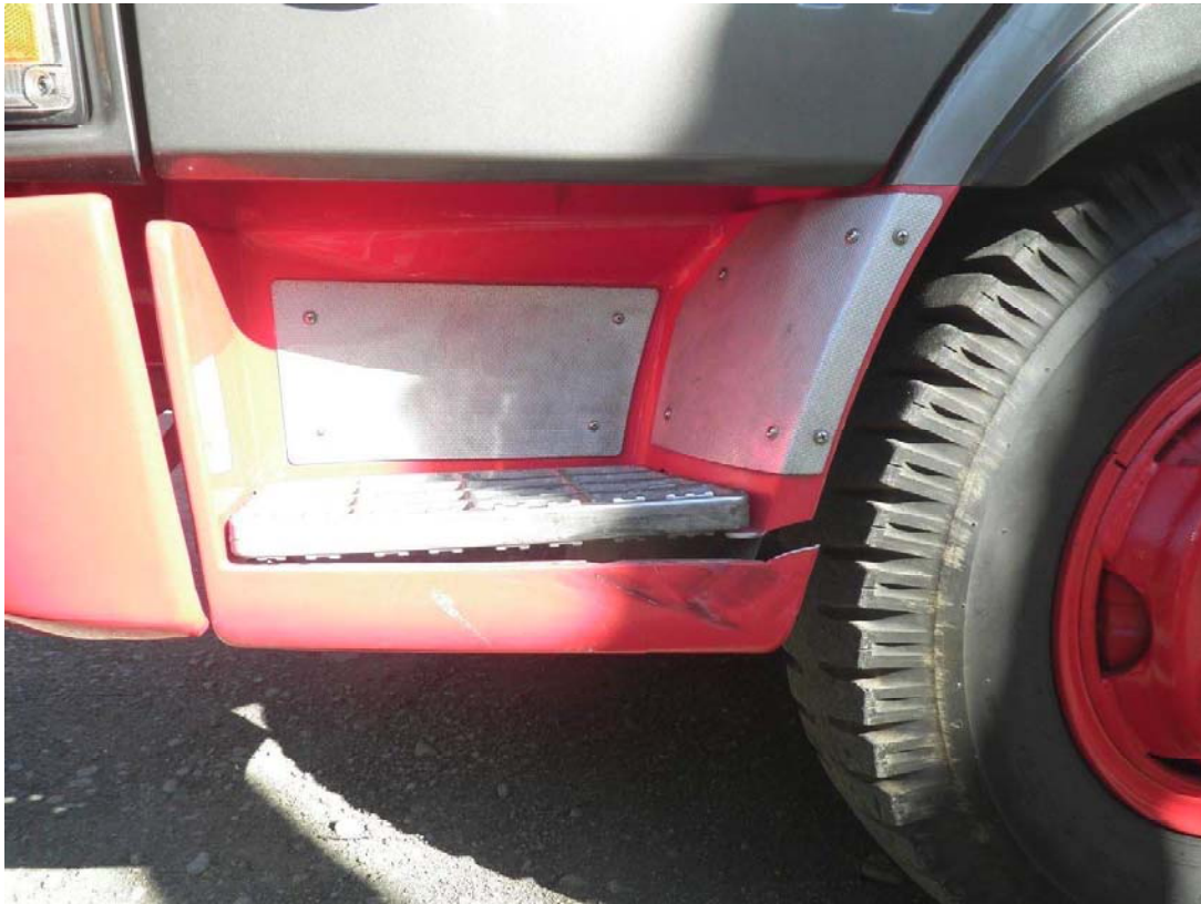
消防車両の乗車部にあるステップ部を破損
