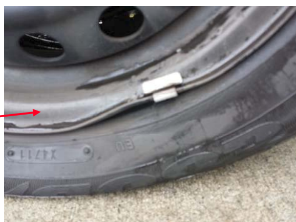
車両損害状況 (ホイール破損)
