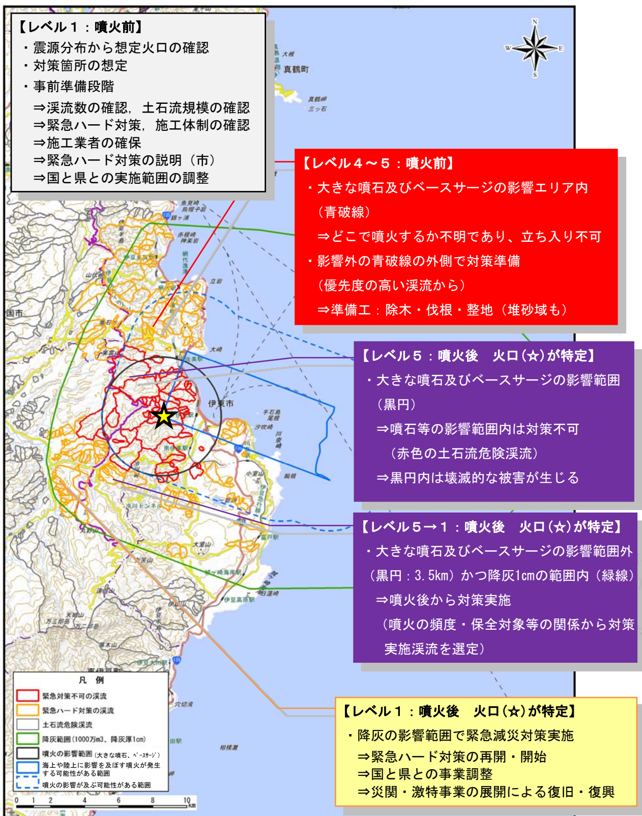
図 3.4.3 緊急ハード対策の方針イメージ（想定火口が南西端の場合）
