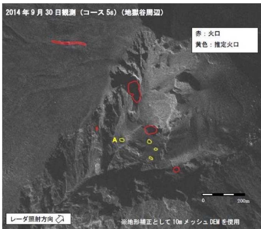
図 5.12.4 御嶽山噴火後の航空機搭載型合成開口レーダー（SAR）の観測画像解析結果から噴火口を推定した事例（リモートセンシング技術）
