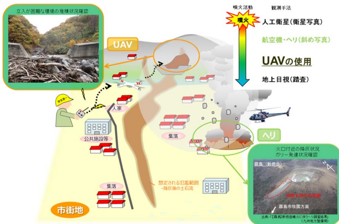
図 2.2.4 緊急調査に実施するUAV等による調査イメージ
