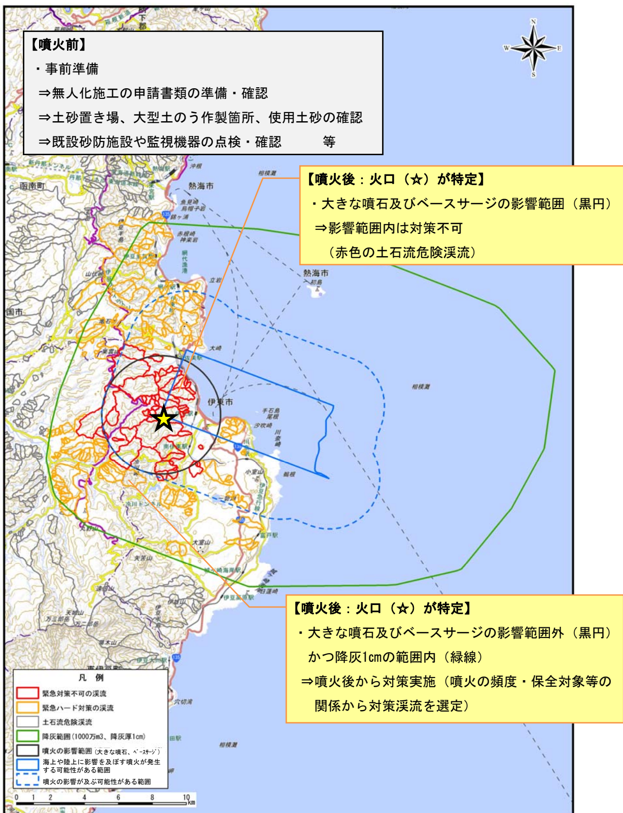
図 1.3.1 対策箇所の設定イメージ（想定火口が南西端の場合）
