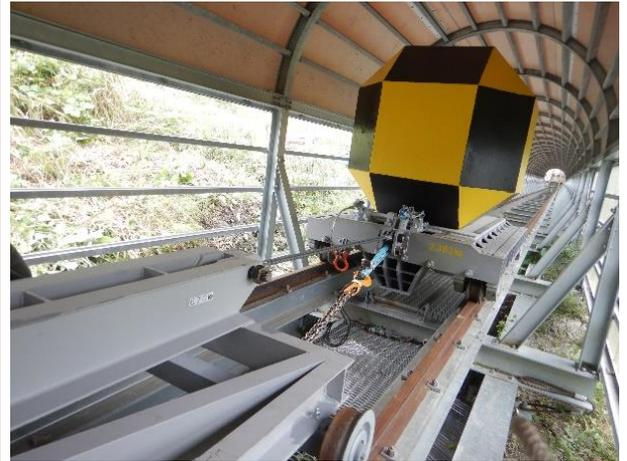
実規模実験状況(重錘の巻き上げ)
