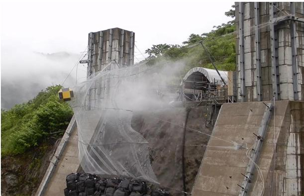
実規模実験状況(捕捉の瞬間)
