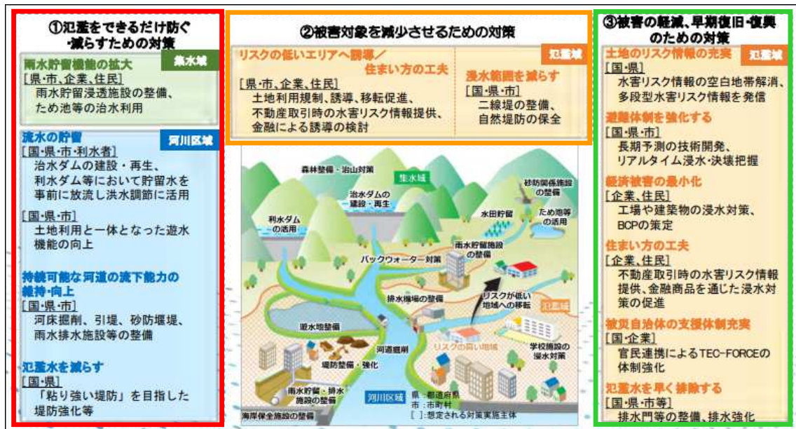
図 5-5 流域治水の「3つの方向性」の概念図
