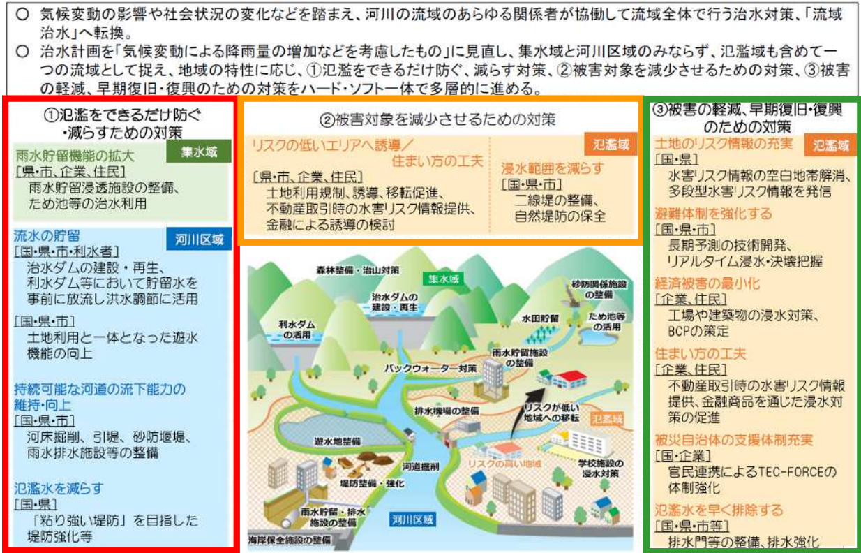
図 5.4 流域治水の「3つの方向性」の概念図
