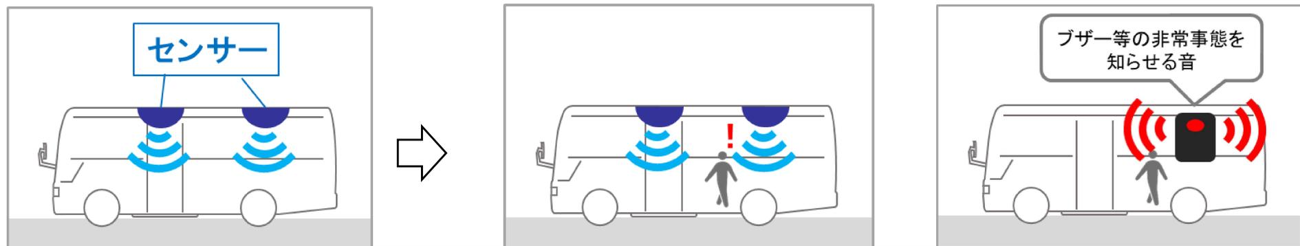
エンジン停止から一定時間後に**センサーによる車内の検知を開始**
