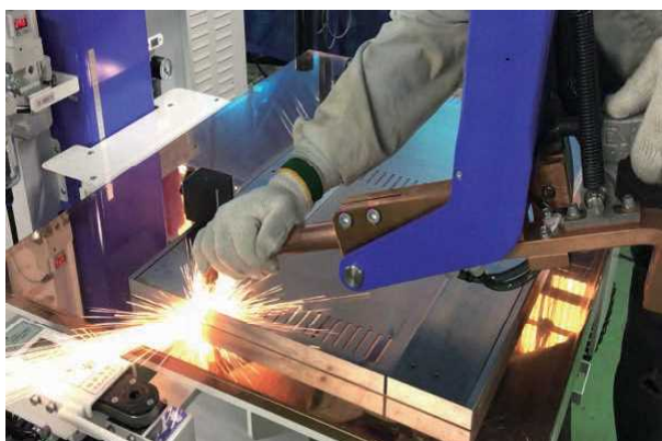
▲令和2年10月に導入したテーブルスポット溶接機
