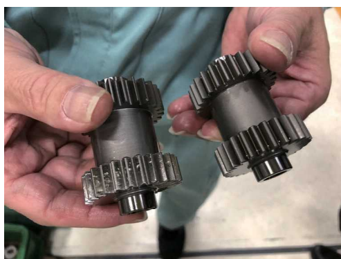
▲ 歯車研削加工前と後のギヤ 左：歯車研削加工後 右：歯車研削加工前
