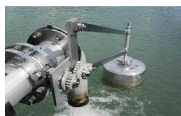
フロートバルブ設置
